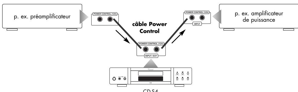
Grâce à un appareil transmetteur, un nombre illimité d'appareils peut être en théorie alimenté avec des impulsions de distribution. Pour ce faire, on pourra utiliser sur la plupart des appareils une des deux prises « POWER CONTROL » comme entrée du signal et l'autre comme sortie du signal. Cette méthode, consistant à mettre en circuit les entrées et les sorties des appareils et de les enchaîner ainsi, est aussi appelée « daisy chaining ».
