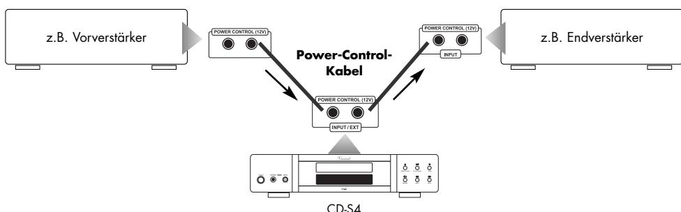
Durch ein sendendes Gerät können theoretisch unendlich viele Geräte mit den Schaltimpulsen versorgt werden. Zu diesem Zweck kann an den meisten Geräten einer der beiden „POWER CONTROL“-Anschlüsse als Signaleingang und der andere als Signalausgang verwendet werden. Diese Methode, das Signal durch Ein- und Ausgänge der Geräte durchzuschleifen und diese somit zu verketten, wird auch als „daisy chaining“ bezeichnet.
