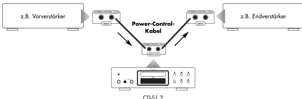
Durch ein sendendes Gerät können theoretisch unendlich viele Geräte mit den Schaltimpulsen versorgt werden. Zu diesem Zweck kann an den meisten Geräten einer der beiden „POWER CONTROL“-Anschlüsse als Signaleingang und der andere als Signalausgang verwendet werden. Diese Methode, das Signal durch Ein- und Ausgänge der Geräte durchzuschleifen und diese somit zu verketten, wird auch als „daisy chaining“ bezeichnet.
