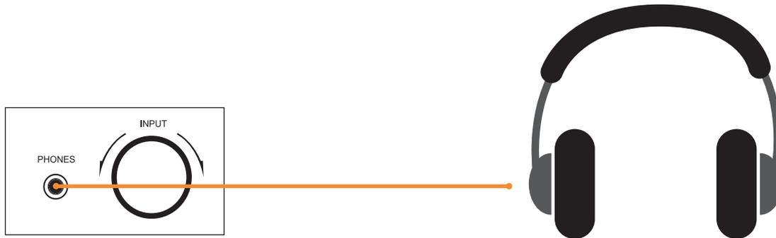
Dadurch werden die Lautsprecher abgeschaltet. Es können alle Kopfhörer mit einer Impedanz zwischen 32 Ohm und 600 Ohm verwendet werden. Ungeeignete Kopfhörer mit zu niedriger Impedanz können den Verstärker beschädigen oder unerwartet eine so hohe Lautstärke produzieren, dass Ihr Gehör geschädigt werden kann. Vor dem Einstecken sollte vorsichtshalber die Lautstärke am Drehknopf bzw. an den Tasten „VOLUME“ (5/20) reduziert werden.
