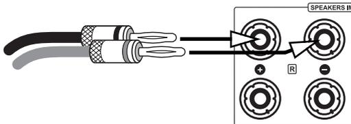
En l'absence de cosse, retirez l'isolant de chaque extrémité du câble sur une longueur d'un cm environ. Torsadez le câble dénudé, pour éviter les court-circuits, desserrez la molette de fixation en la tournant dans le sens antihoraire et insérez l'extrémité du câble dans le perçage dégagé du bornier. Serrez maintenant le câble en faisant tourner la molette de serrage dans le sens horaire. Contrôlez le serrage correct du câble.
