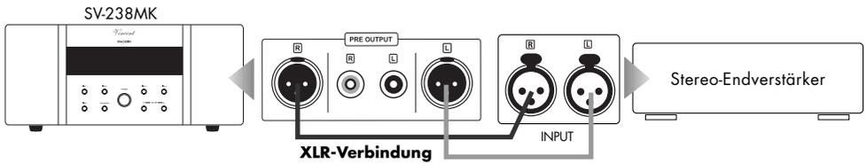
Beide Stereo-Vorverstärkerausgänge liefern das gleiche Stereo-Musiksignal. Anstelle der hier gezeigten Stereo-Endverstärker können auch jeweils zwei Mono-Endverstärker eingesetzt werden.
