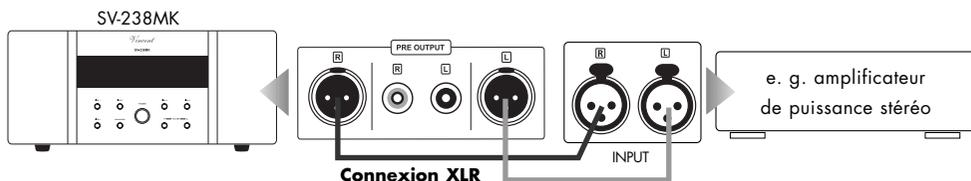
Les deux sorties du préamplificateur stéréo offrent le même signal musique stéréo. A la place de l'amplificateur de puissance stéréo représenté ici, on peut aussi bien utiliser deux amplificateurs de puissance mono.
