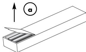
b) Retirez éventuellement les piles usagées et insérez correctement les piles neuves comme indiqué sur le schéma dans le compartiment des piles.
