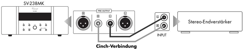
Zwei weitere Endstufenkanäle können mittels XLR-Verbindungen angeschlossen werden.
