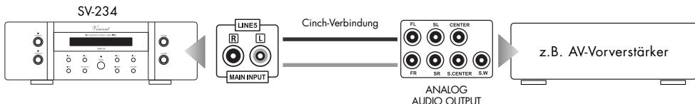
Ist der Eingang „LINE5“ gewählt, verhält sich der Verstärker SV-234 wie eine Stereo-Endstufe. Wenn sich der Verstärker SV-234 beim Betrieb als Endstufe automatisch mit dem Vorverstärker ausschalten soll, müssen die nachfolgend beschriebenen Kabelverbindungen für die Einschaltsteuerung richtig vorgenommen werden.
