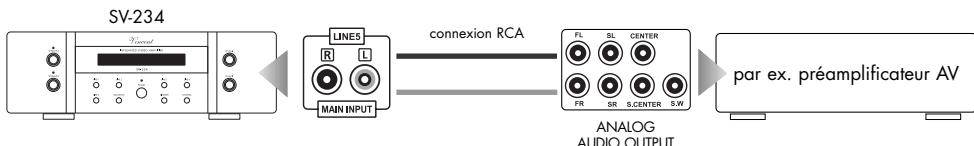
Si l'entrée "LINE 5" est sélectionnée, l'amplificateur SV-234 se comporte comme un étage de sortie stéréo. Si l'amplificateur SV-234 utilisé comme étage de sortie, doit être automatiquement mis à l'arrêt en même temps que le préamplificateur, les liaisons par câbles décrites ci-dessous doivent être effectuées correctement pour la commande de mise sous tension.
