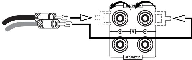
Andernfalls entfernen Sie ein ca. 1 cm langes Stück der Isolierung von jedem Endstück des Lautsprecherdrähtes. Verdrillen Sie die blanke Litze, um Kurzschlüsse zu vermeiden. Drehen Sie den Knopf der Lautsprecherklemme im Gegenuhzeigersinn, um ihn zu lösen und führen Sie das blanke Drahtende in das nun freiliegende Klemmenloch ein. Drehen Sie den Knopf nun im Uhrzeigersinn, um den Draht in der Lautsprecherklemme festzuklemmen. Achten Sie darauf, dass die Verschraubung fest ist.
