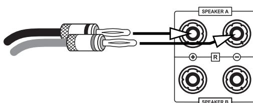
Sollen Kabelschuhe verwendet werden, muss an jeder Klemme der Schraubkopf im Gegenuhrzeigersinn gelöst, der Kabelschuh daruntergeschoben und die Schraubkappe im Uhrzeigersinn festgedreht werden. Stellen Sie zur Vermeidung von Schäden sicher, dass der Anschluss fest sitzt und kein blankes Metall von den Kabelschuhen die Rückwand oder einen anderen Anschluss berührt.
