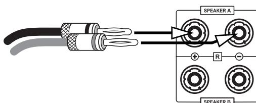
Si on utilise des câbles avec cosses, il faudra desserrer la molette de fixation en la tournant dans le sens antihoraire, insérer la cosse sous la molette et resserrer celle-ci en la tournant dans le sens horaire. Pour éviter tout dommage, assurez-vous que le branchement est bien serré et qu'aucune partie métallique dénudée de la cosse ne soit en contact avec la paroi arrière ou une autre borne de raccordement.
