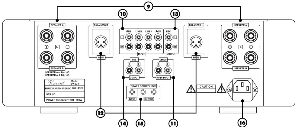
**9. SPEAKER: Lautsprecheranschlussklemmen** Ausgangsbuchsen mit Schraubklemmen zum Anschluss von einem oder zwei Lautsprecherpaaren. Es können Lautsprecherkabel mit 4 mm Bananensteckern verwendet werden. Beachten Sie die Hinweise im Kapitel „Installation“ für den Fall, dass zwei Lautsprecherpaare angeschlossen werden sollen.
