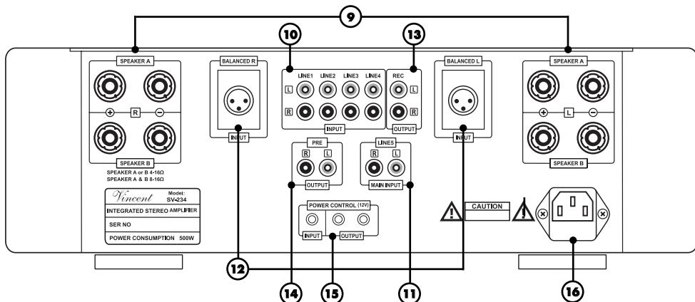
**9. SPEAKER : bornes de raccordement des haut-parleurs** Douilles de sortie avec serrage à vis pour le raccordement d'une ou de deux paires de haut-parleurs. On peut utiliser des câbles de haut-parleurs avec fiches banane de 4 mm. Respectez les instructions du chapitre "Installation" dans le cas où deux paires de haut-parleurs doivent être raccordées.
